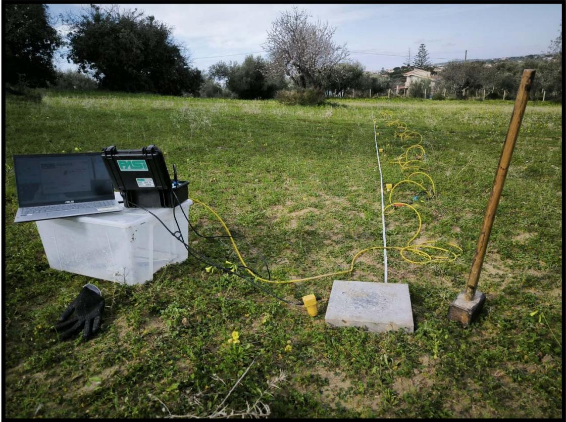
Foto sismica Masw postazione n°1
